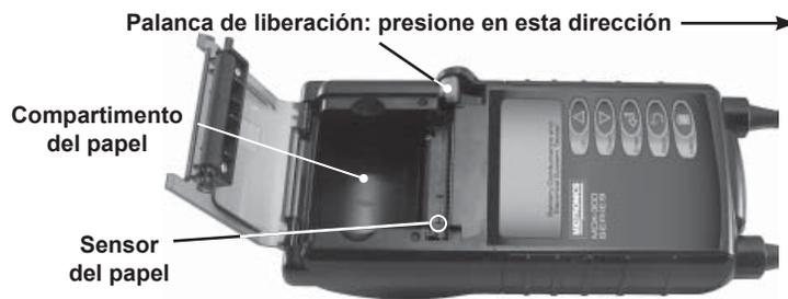
2. Coloque un nuevo rollo de papel en el compartimento y tire del papel hacia delante hasta que sobresalga por el borde serrado de la ranura del papel.
