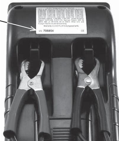
La parte posterior del comprobador también dispone de una sujeción para las pinzas con el fin de que estén recogidas cuando no se utilicen.
