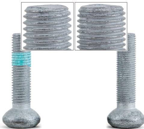
Fig. 1: Tornillo izquierdo: M12x1,5 Tornillo derecho: M12x1,25
